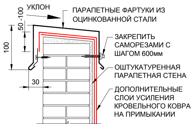
Рис. 46 Примыкание кровельного ковра к парапетной стене высотой менее 500мм.
