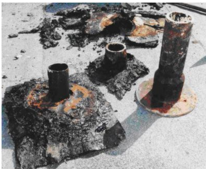
Foto Uue ja vana äravoolu ebatiheda liitumise tõttu esineb sageli läbijookse. Püsivalt veetihe liide on võimalik vaid juhul, kui vahetatakse vähemalt osaliselt ka äravoolutorustik. Ümber pööratud uue äravoolu alumine hüdroisolatsioonilapp pole vana äravooluga liitunud. Sellest ka rooste jäljed.
